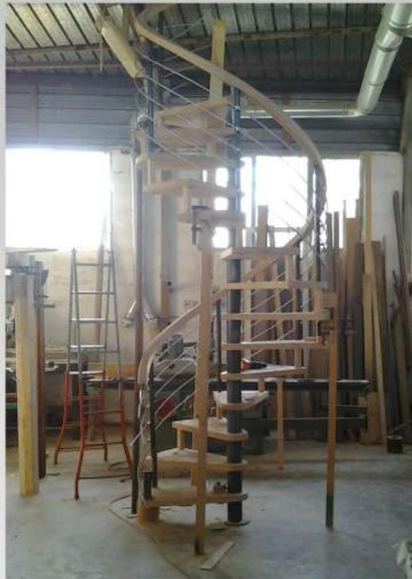
**Tutti i prodotti di Progetto Casa Scale vengono premontati ancora grezzi in laboratorio dove si verificano la robustezza la stabilità e aspetto.**
